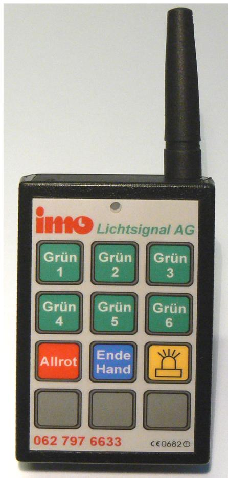
Mit diesem Handsender kann die Lichtsignal-Anlage manuell geschaltet werden. Grün 1 ist immer die Ampel mit dem Sendersteuergerät.
